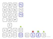
mechanischen Messstellen einschalten. Jeweils die nächste freie Messzelle wird nach der Pipettierung mit einer automatischen Pipette für den Messungsstart vorbereitet bzw. aktiviert. Diese Aktivierungsautomatik können Sie auch einschalten in dem Sie die Aktivierungstaste der nächsten zu pipettierenden mechanischen Messzelle gedrückt halten bis alle folgenden Messungen gestartet wurden.
